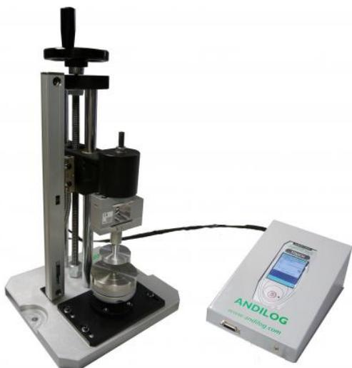
Il Springtest 2 è stato progettato appositamente per la misurazione precisa delle molle di compressione. Questo banco prova manuale con misuratore di forza o cella di carico esterna e righello digitale è adatto per la misura di molle di piccole dimensioni e campi di forza.
