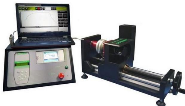
Il comando del motore e l'acquisizione delle misure avviene tramite il controllore DriveTouch. Grazie alla sua capacità di leggere simultaneamente i dati provenienti da due sensori ad una frequenza di campionamento di 1.000 Hz, il DriveTouch misura i dati dal torsionometro statico e dall'encoder rotativo.
