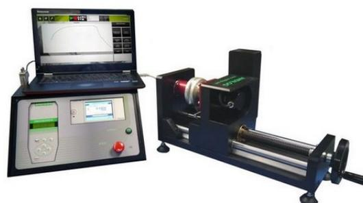
**Drivetwist** - Misura motorizzata della coppia e dell'angolo
