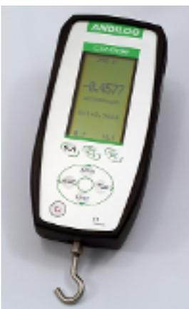
I dinamometri Centor Easy sono progettati per soddisfare le esigenze produttive dei suoi utilizzatori. Offrono caratteristiche indispensabili per i controlli di qualità, quali: **facilità di lettura con il suo ampio display grafico retroilluminato, memoria interna degli ultimi 100 valori, uscita RS232 e possibilità di impostare soglie con allarmi visivi e sonori**. La filettatura M5 sul retro del dispositivo ne consente il montaggio sui Springtest.
